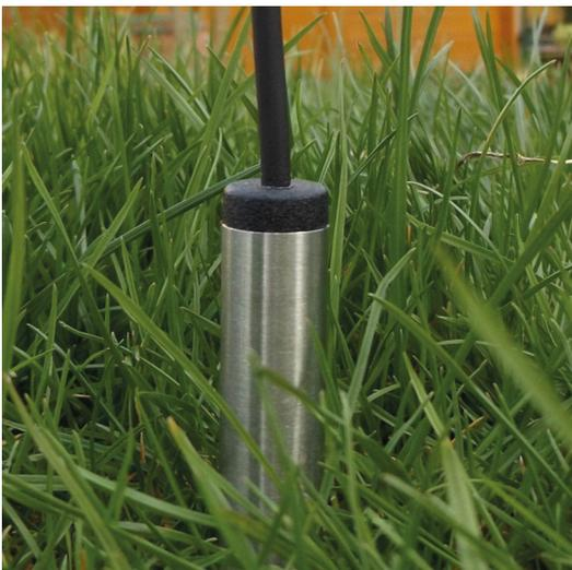
T100 zur Bodentemperaturmessung
